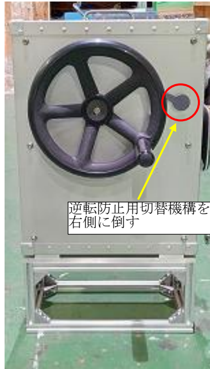
図.5－6 巻取りユニットの逆転防止用切替機構の操作
