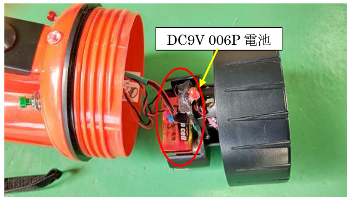
図. 2 - 1 5 データ記録指示ユニット内部
