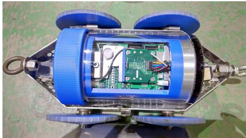
図.2-2 位置探索ユニット (蓋を外した状態)
